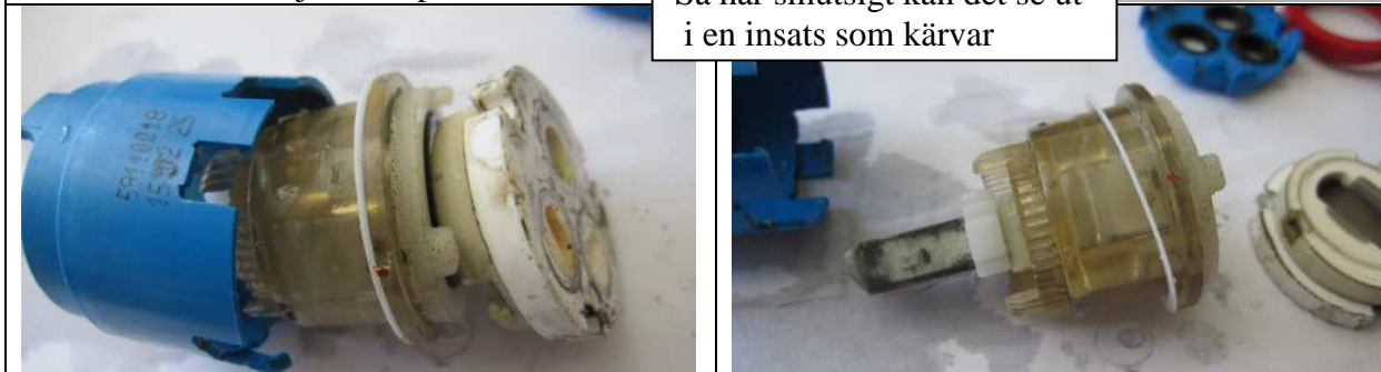
Bänd med skruvmejsel och plocka isär
