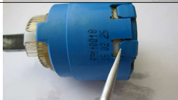
Bänd med skruvmejsel och plocka isär
