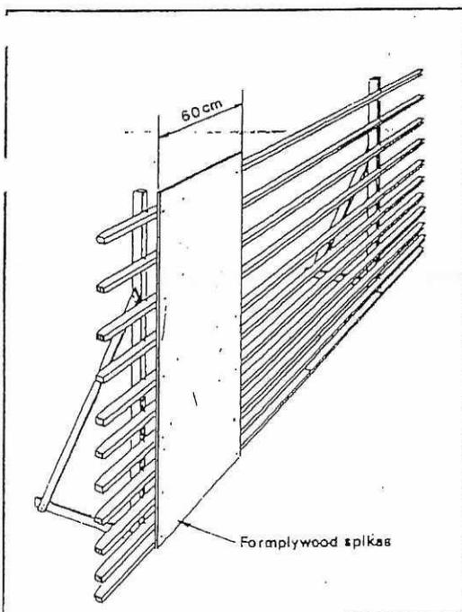
Kompletera ståndarna efter hand. Borra och montera formstag i skarven mellan skivorna. Använd förborrade hål.
