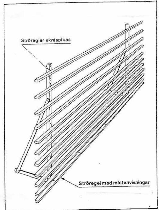
Skråspika ströreglarna på plats. Skarva reglarna genom omlottläggning.
