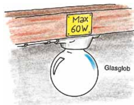
Figur 7.4 Skyddsglob ska alltid vara monterad.
