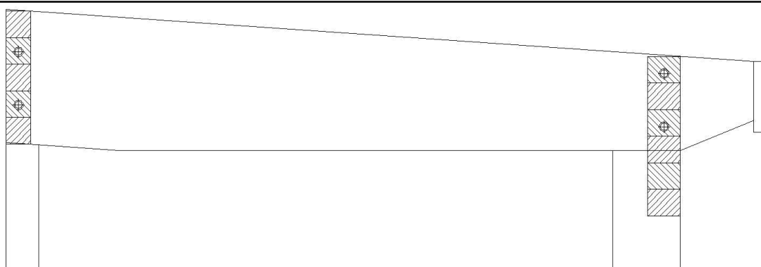
Infästning av gaveltakbalk - skruv 6,0 x 100 mm
